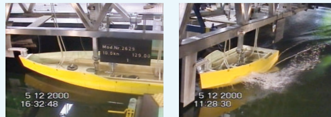
Der Rumpf der K46 wurde in vielen Schleppläufen bei der Versuchsanstalt für Wasserbau und Schiffbau (WWS) in Berlin erprobt, sowohl im Glattwasser als auch bei Seegang
